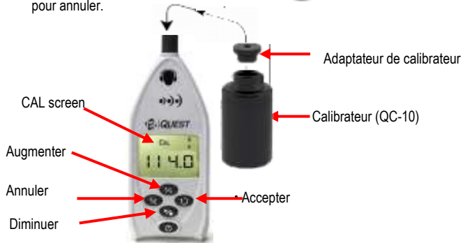
Figure 1-10 : Étalonnage du SD-200
