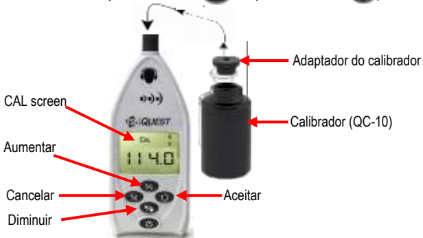
Figura 1-10: Calibração do SD-200
